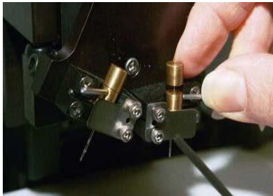
Abb. 9. Ersatz einer Stanze durch das Lösen der Schrauben im Kunststoff V-Block. Beachten Sie bitte den korrekte Sitz auf der linken Seite mit dem Handgriff der Stanze über dem glänzenden Metallklipp.
