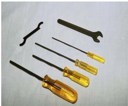
Abb.9. Werkzeug Satz bestehend aus Gabelschlüssel, Inbusschlüssel und Spezialwerkzeug zur Justage der Mikrometer.
