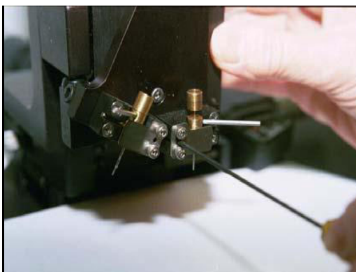
Abb. 3. Justage der Y-Achse (vorne-hinten) durch drehen der Klemmschraube mit einem Inbuschlüssel, die sich hinter dem glänzenden Halter der Stanzen befindet. Diese Justageschrauben sind erst bei Geräten vorhanden die nach dem März 2000 ausgeliefert wurden.
